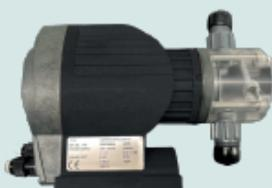
Un électro-aimant déplace l'axe magnétique vers l'avant et vers l'arrière. Ce mouvement est transmis à la membrane de dosage installée dans la tête doseuse. Deux clapets anti-retour empêchent l'inversion du mouvement du fluide de dosage pendant le procédé de pompage. Le débit de dosage d'une pompe doseuse électromagnétique peut être réglé avec précision par la longueur de course et la fréquence d'impulsions.
