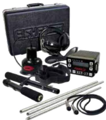
Le détecteur XLT-17 repère les fuites de canalisations (en pression) par écoute amplifiée électroniquement des bruits souterrains.
