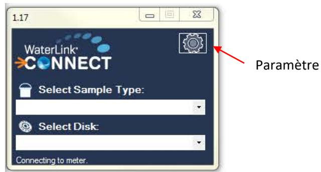
Cocher « write data to a file » puis cliquer sur « ... » et chercher le disque « C:\ » et sélectionner « LaMotteWLS » et « OK ».
