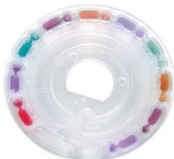
L'échantillon d'eau à analyser est injecté dans un disque unique contenant tous les réactifs dans des chambres individuelles étanches.
