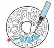
4. Vérifier que le disque est sec (sinon le sécher avec un tissu). Tenir le disque par les bords et non pas par le dessus au risque de fausser l'analyse.
