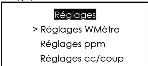
Par les touches HAUT/BAS on sélectionne la ligne du Menu (identifiée par le symbole ">") et en appuyant sur la touche ENT on sélectionne le paramètre qui nous intéresse.
