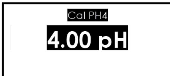
Insérer la sonde dans la solution pH 4.0 (exemple), attendre quelques secondes que la mesure se stabilise, donc par les touches HAUT/BAS déplacer sur l'afficheur la valeur jusqu'à 4.00. Appuyer ENT pour confirmer et conclure la calibration. En appuyant ESC on sort de la procédure de calibration.
