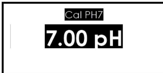
Insérer la sonde dans la solution pH 7.0, attendre quelques secondes que la mesure se stabilise, donc par les touches HAUT/BAS déplacer sur l'afficheur la valeur jusqu'à 7.00. Appuyer ENT pour confirmer. En appuyant ESC on sort de la procédure de calibration.
