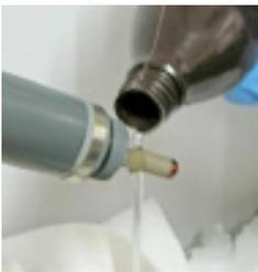
Lorsque la pointe est bien imprégnée, remplir la membrane d'électrolyte à ras bord et le faire lentement afin de faire en sorte qu'il n'y ait pas de bulles d'air dans la membrane.
